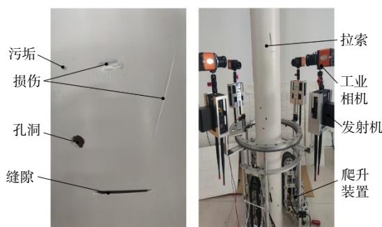
图 11 拉索表面缺陷数据采集
