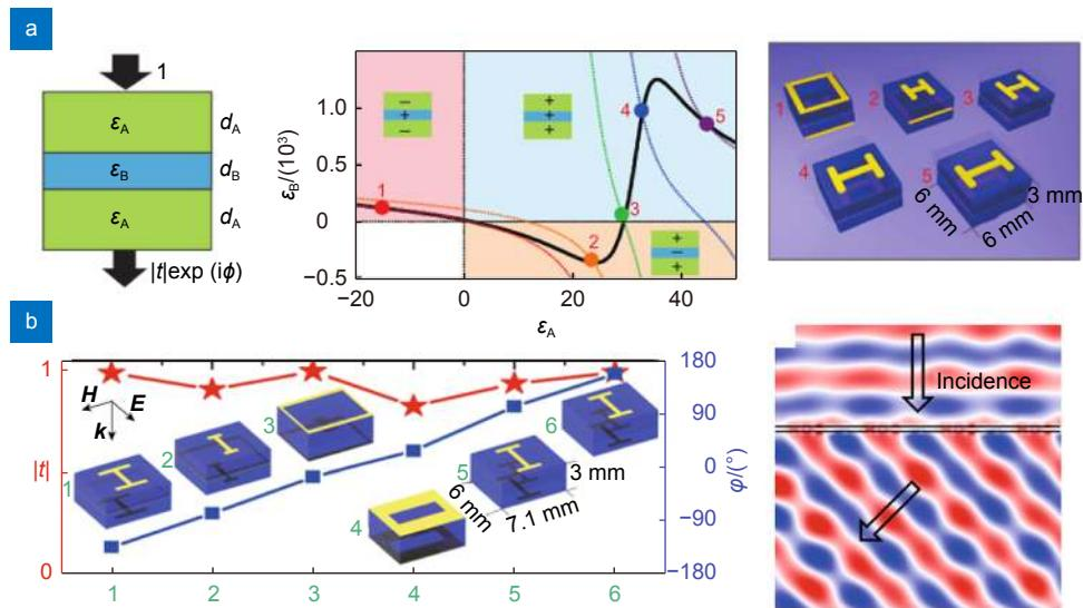
图 2 多层结构的无反射超构表面。(a) ABA 型的超构表面结构单元及机理<sup>[59]</sup>;
