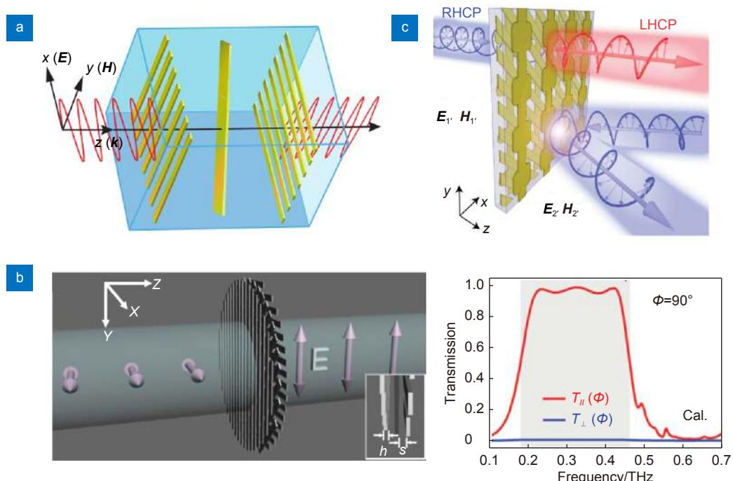
图7 偏振操控。(a) 太赫兹各向异性超构表面偏振转换器<sup>[72]</sup>; (b) 可调控的太赫兹各向异性超构表面偏振转换器<sup>[74]</sup>; (c) 双各向异性超构表面偏振转换器<sup>[73]</sup>
