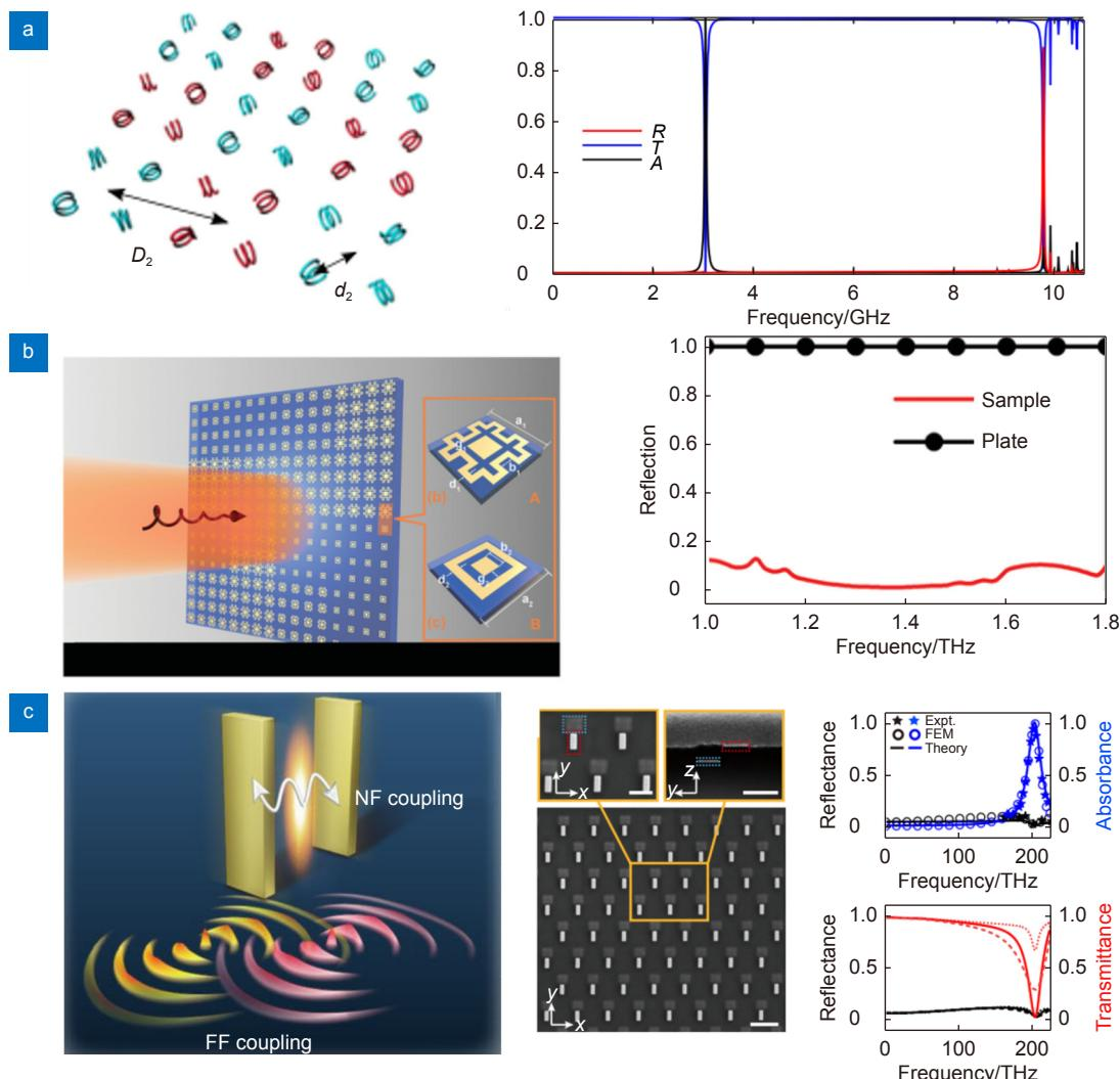
图5 宽频无反射超构表面。(a) 基于螺旋型微结构单元的宽频无反射微波超构表面<sup>[99]</sup>; (b) 利用优化算法设计的宽带低反射的太赫兹超构表面<sup>[157]</sup>; (c) 由双层微结构单元组成的超宽频无反射超构表面<sup>[158]</sup>
