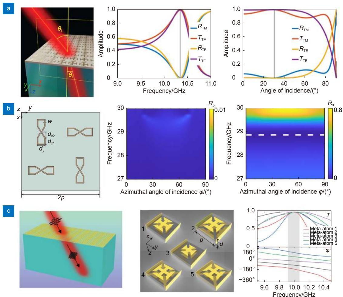
图 8 超构减反膜。(a) H 形金属结构构成的双各向异性超构减反膜<sup>[194]</sup>; (b) S 形金属结构构成双各向异性超构减反膜<sup>[195]</sup>; (c) 同时消除反射和调控波前的超构减反膜<sup>[123]</sup>
