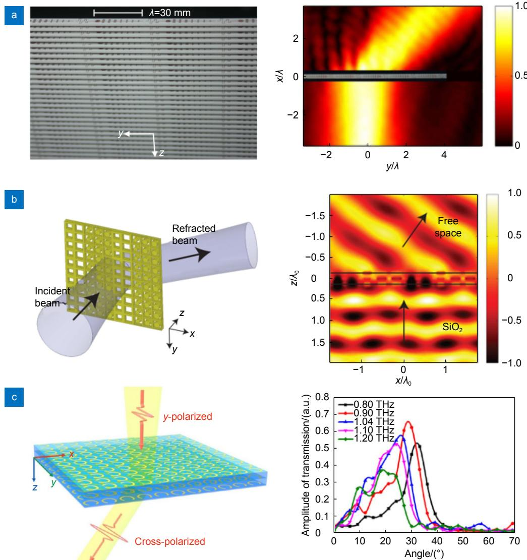
图 6 异常折射。(a) 微波频段的梯度惠更斯超构表面<sup>[51]</sup>; (b) 近红外波段的梯度惠更斯超构表面<sup>[95]</sup>; (c) 太赫兹频段的无反射的梯度编码超构表面<sup>[193]</sup>
