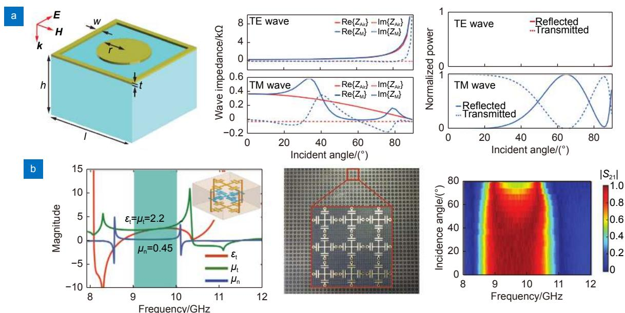
图4 广角无反射超构表面。(a) 对TE波广角无反射的太赫兹超构表面<sup>[146]</sup>; (b) 对TE波广角无反射的微波超构表面<sup>[152]</sup>
