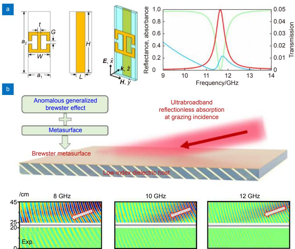
图9 电磁波完美吸收。(a) 基于谐振型超构表面的电磁波完美吸收<sup>[77]</sup>;
