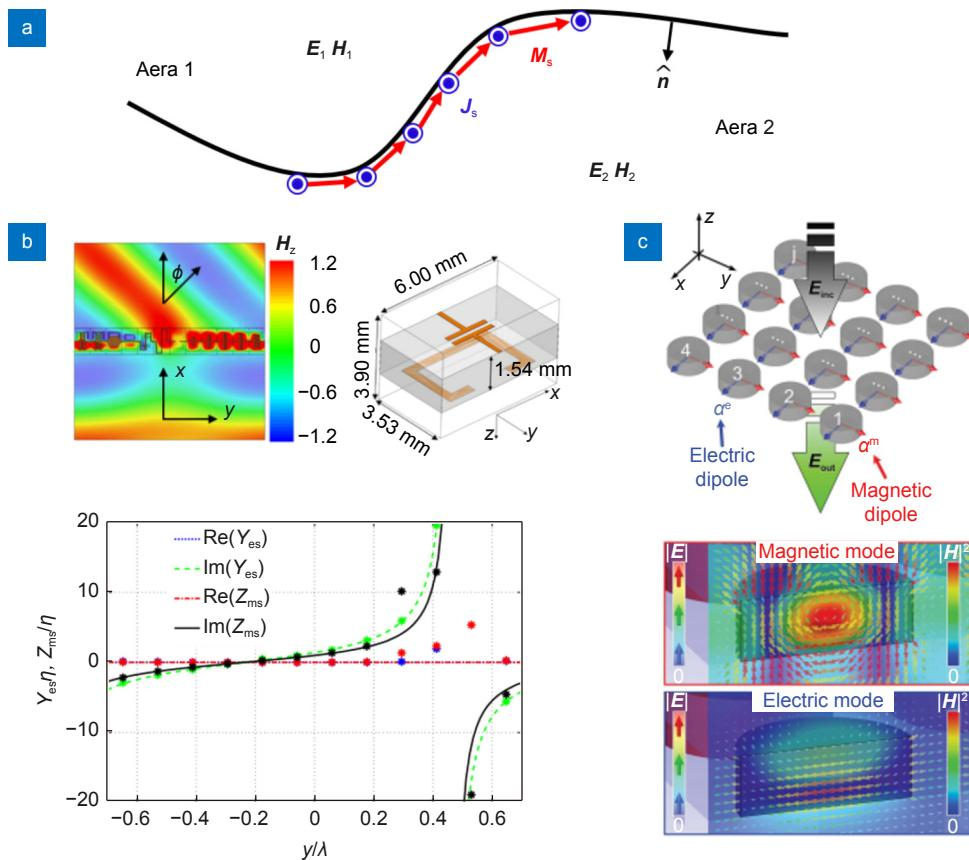
图 1 惠更斯超构表面。(a) 惠更斯超构表面的物理机制示意图<sup>[93]</sup>; (b) 金属结构的惠更斯超构表面<sup>[51]</sup>; (c) 全电介质惠更斯超构表面<sup>[92]</sup>
