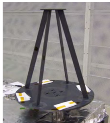
图 11 SiC 结构稳定性样件 [40]
