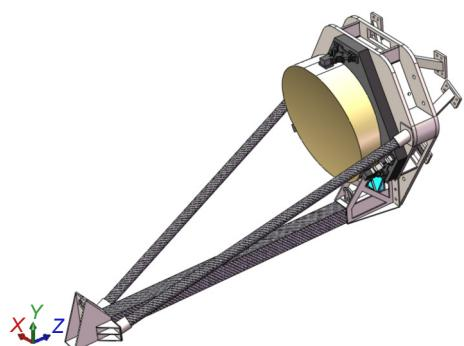
图 7 主支撑结构模型与坐标系
