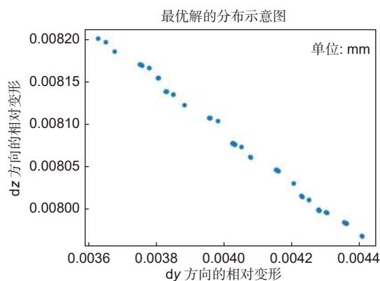
图 10 对结构热变形的参数优化结果
