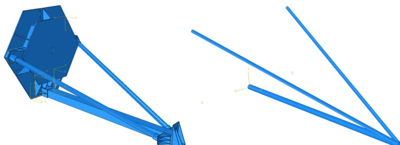
图 8 实体单元模型 (左); 桁架杆单元模型 (中); 理论模型 (右)
