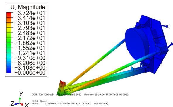
图 12 第二阶振型: 沿 X 方向摆动, 128.47 Hz
