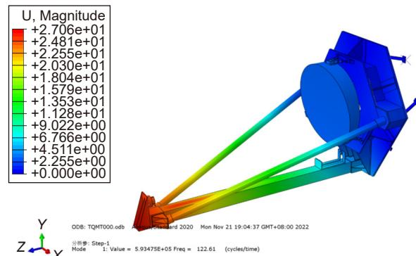
图 11 第一阶振型: 沿 Y 方向摆动, 122.61 Hz
