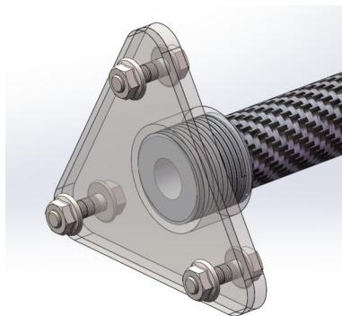
图 4 可更换式望远镜 CFRP 支撑杆接头
