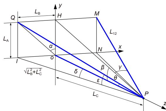
图 5 桁架支撑结构的几何模型
