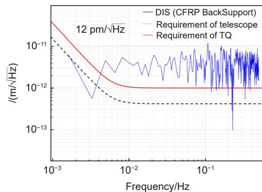
图 15 主次镜间隔相对热变形为  $12 \text{ pm}/\sqrt{\text{Hz}}$
