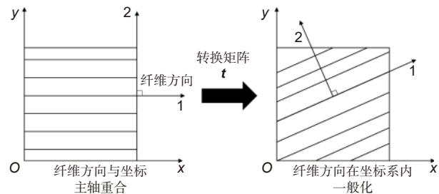
图 1 单层 CFRP 示意图。方向 1 为面内纤维方向, 简称纵向; 方向 2 与方向 1 面内垂直, 简称横向
