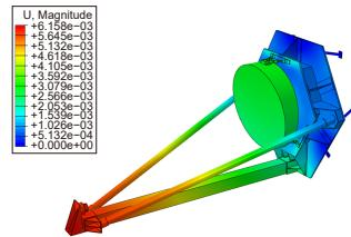
**摘要:** 本文针对引力波探测望远镜超低热变形要求, 提出了通过设计 CFRP 铺层改变材料热胀系数的方法, 进而解决桁架支撑结构热变形问题。同时针对望远镜装调性能的要求, 给出了结构的分段式设计方案。文章首先分析了 CFRP 的优势、现有的消热化的方式和国内外研究进展, 确定了以 CFRP 为关键材料的三杆式望远镜的方案, 并提出了设计指标。其次建立了“材料-热变形、桁架结构-热变形”数学模型, 针对材料铺层和结构设计进行优化, 给出了优化方案。然后将 CFRP 材料应用于支撑结构中, 采用分段式主支撑结构设计方案, 降低了结构加工装调的难度, 最后对整体结构进行分析。分析结果表明: 机械性能方面, 结构基频和最大重力卸载变形满足主支撑结构的要求; 热变形方面, 基于 CFRP 铺层特定优化设计的结构方案热变形为普通铺层方案的 27.15%、Invar 材料支杆方案的 6.42%、SiC 支杆方案的 11.50% 和钛合金支杆方案的 3.21%, 即优化设计可显著降低结构热变形。
