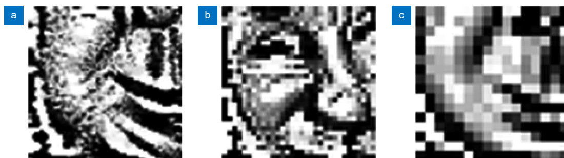
图 10 采用灰度化 BALA 生成不同的均值对抗扰动块。(a) 无均值法生成的扰动块; (b) 采用 2 \times 2 邻域均值化生成的扰动块; (c) 采用 4 \times 4 邻域均值化生成的扰动块
