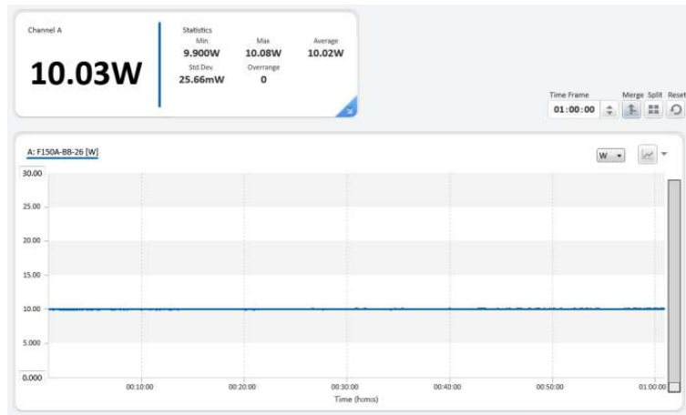
图 4 激光器功率稳定性测试 Fig. 4 Laser power stability test
