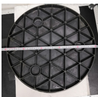
图 14 \Phi 500 mm 轻量化 SiC 镜坯
