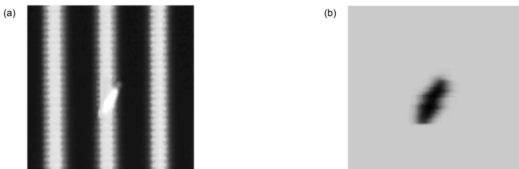
图 5 划痕缺陷的检测结果
