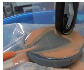
**摘要:** 本文结合机器人控制和轮式抛光技术的优点, 开展了轮式技术研究。运用数值仿真模拟其抛光加工, 论证了轮式抛光工具在精密元件抛光过程中的可行性; 设计了可在机器人末端安装的轮式抛光工具, 分析机器人轮式抛光控制逻辑和控制框架, 建立基于轨迹和驻留时间的机器人抛光控制模型; 开展机器人轮式抛光单点去除特性和环带去除特性性能测试实验, 确定机器人轮式抛光工艺参数, 实现样件表面整体自动研抛加工, 面形误差由初始值 PV: 2.357 $\lambda$ , RMS: 0.565 $\lambda$ , 收敛到 PV: 1.431 $\lambda$ , RMS: 0.242 $\lambda$ , 初步达到预期的去除效果。研究表明, 工业机器人轮式抛光方法是一种有效的表面抛光方法, 在中高精度非球面元件的抛光中具有很大的潜力。
