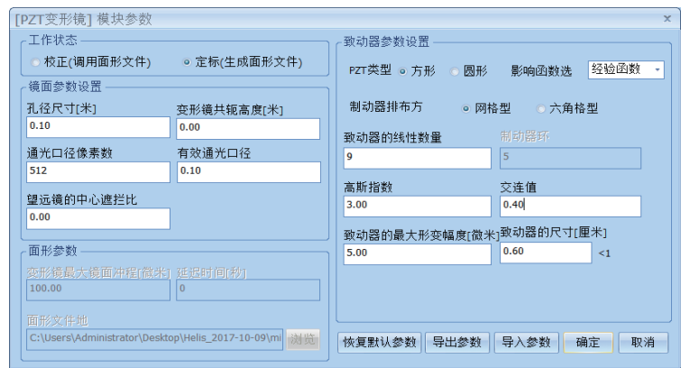
图 5 PZT 变形镜模块参数设置界面 Fig. 5 The parameters setting interface of PZT deformable mirror
