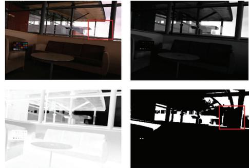
**摘要:** 针对目前自动白平衡算法中存在的白色区域检测错误导致白平衡失效的问题, 本文提出了一种基于暗通道优先的白平衡算法。首先估计光线透射率, 然后根据光线透射率来提取白色区域, 去除掉高饱和度的区域。最后为了校正颜色并保证图像亮度不变化, 在 CIE-XYZ 颜色空间相对于亮度通道 Y 来计算校正增益。实验表明, 本文的算法和现有的一些经典算法相比, 在主观视觉和客观评价上都取得了较好的效果, 且在嵌入式设备上速率大于 150 frames/s。
