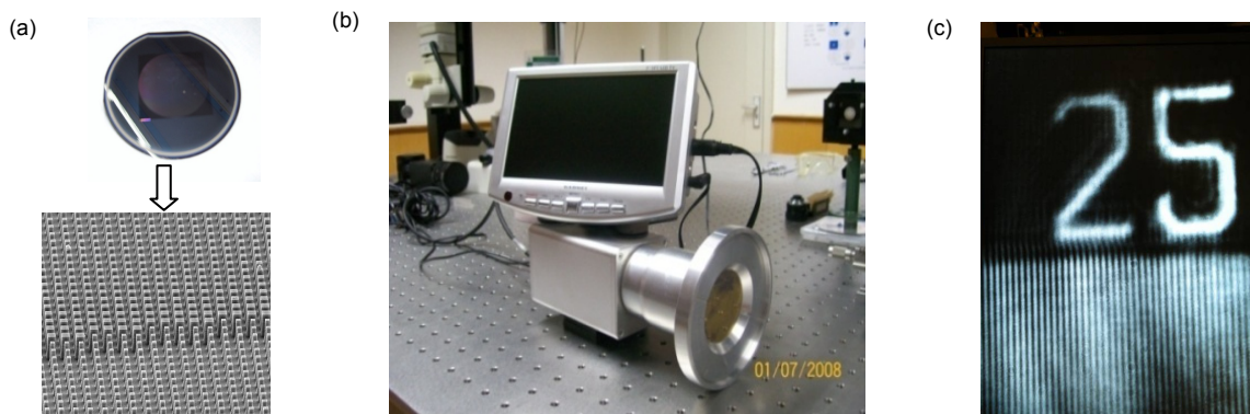
图 7 (a) 微结构薄膜主镜. (b) 原理样机. (c) 近衍射极限成像.
