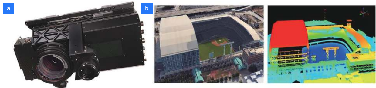
图 16 徕卡 SPL100 与获取的地物信息 [57] 。(a) 徕卡 SPL100 系统; (b) SPL100 重建结果
