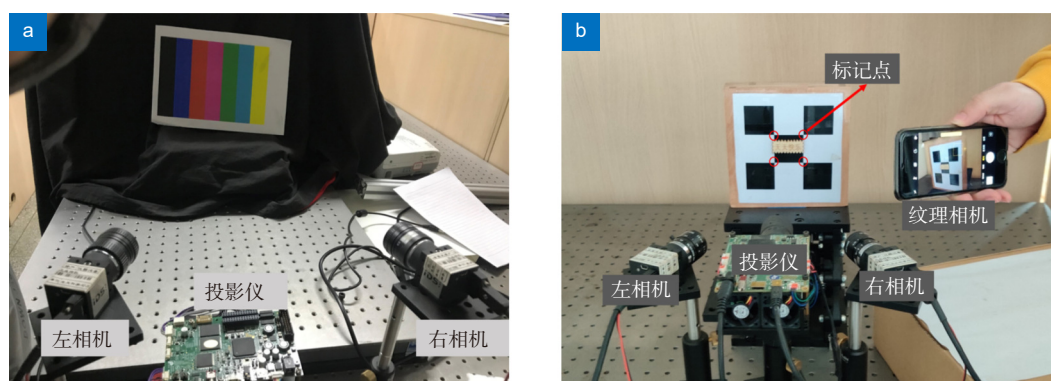
图 4 实验装置图。(a) 固视纹理映射实验装置; (b) 自由视角纹理映射实验装置
