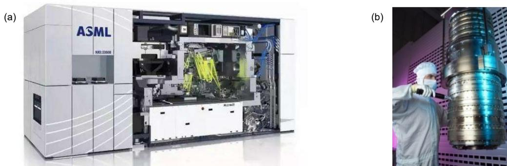
图 5 (a) ASML EUV 光刻机; (b) 投影物镜系统<sup>[15]</sup>
