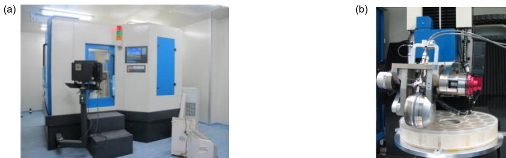
图 12 国防科大研发的磁流变抛光设备(a)及工作图(b)
