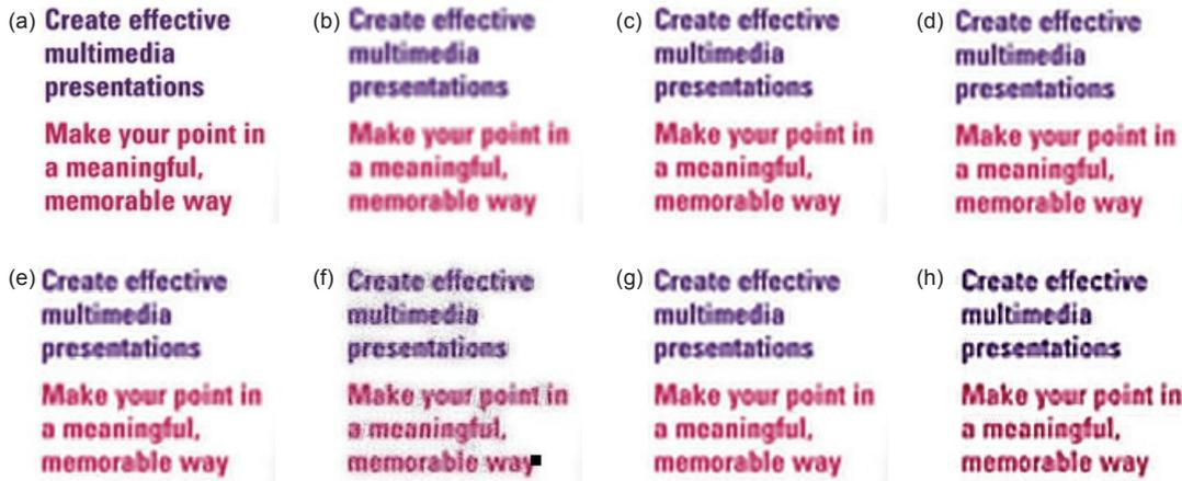
图 5 图片 PPT 超分辨率重建效果图。(a) 原图; (b) Bicubic 方法; (c) Zeyde 方法; (d) NE+LLE 方法; (e) NE+NNLS 方法; (f) SF 方法; (g) ANR 方法; (h) 本文方法
