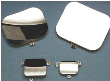
图 9 雷神公司通过 MRF 修正的离轴自由曲面铝反射镜 [18]
