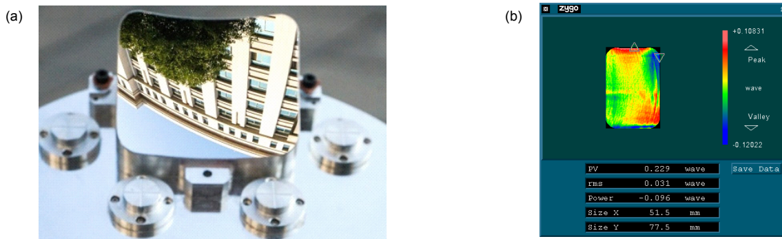
图 8 磁流变、光顺加工后自由曲面铝反射镜 [1]
