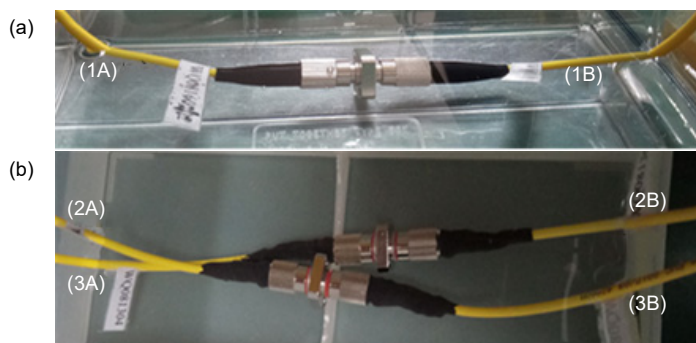
图 5 组合体置于室水中浸没试验。(a) 普通组合体浸没试验; (b) 新工艺组合体浸没试验
