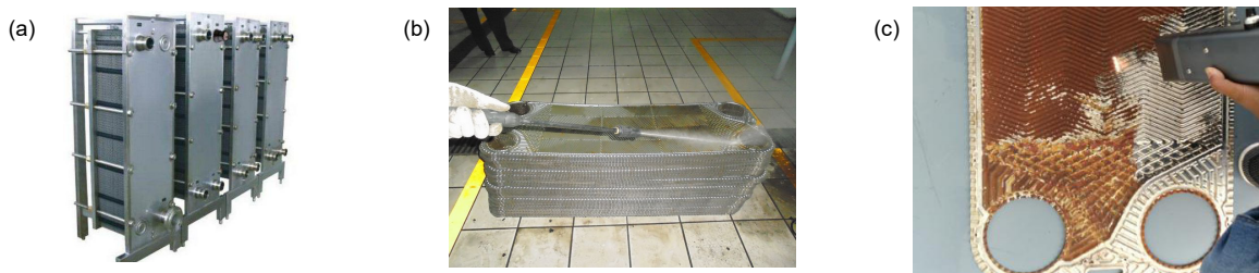
图 9 (a) 板式换热器 [12] ; (b) 高压水清洗换热板 [12] ; (c) 激光清洗换热板
