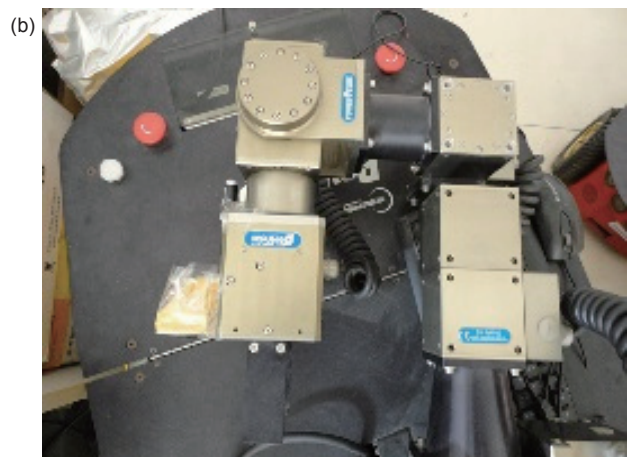
图 4 Powercube 机械臂与 Powerbot。(a) Powerbot; (b) Powercube
