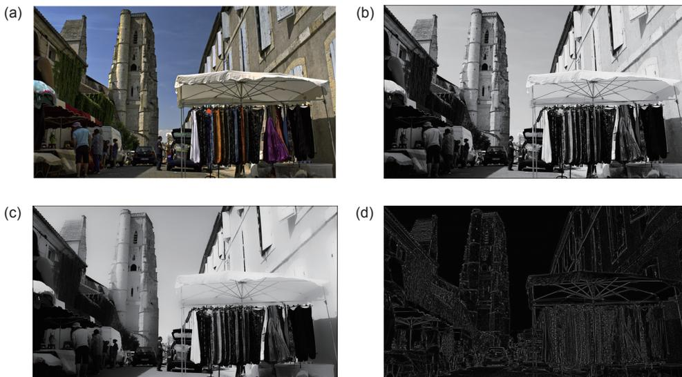
图4 Market3序列第1帧图像及其细节层。(a)原始图像帧; (b)原始图像帧灰度图; (c)基本层图像; (d)细节层图像
