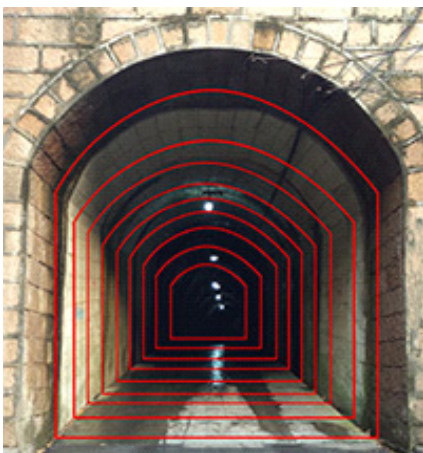
图 2 圆形激光器扫描示意图。 Fig. 2 The scanning diagram of the circular laser.
