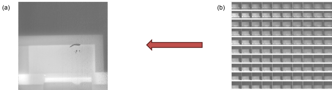
图 4 太赫兹光场图像。(a) 单张子图像；(b) 不同位置与不同角度的子图像阵列 Fig. 4 Terahertz light field images. (a) A subimage; (b) Subimages with different positions and angles
